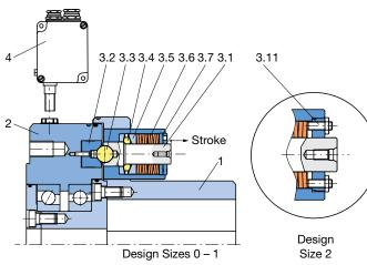
Fig. 1: EAS<sup>®</sup>-element clutch engaged
